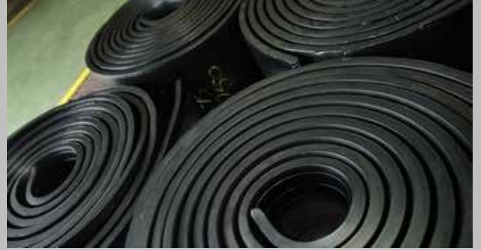
Üretimden sonra deve sırtı sırt şeritleri. Camelback threads after production
